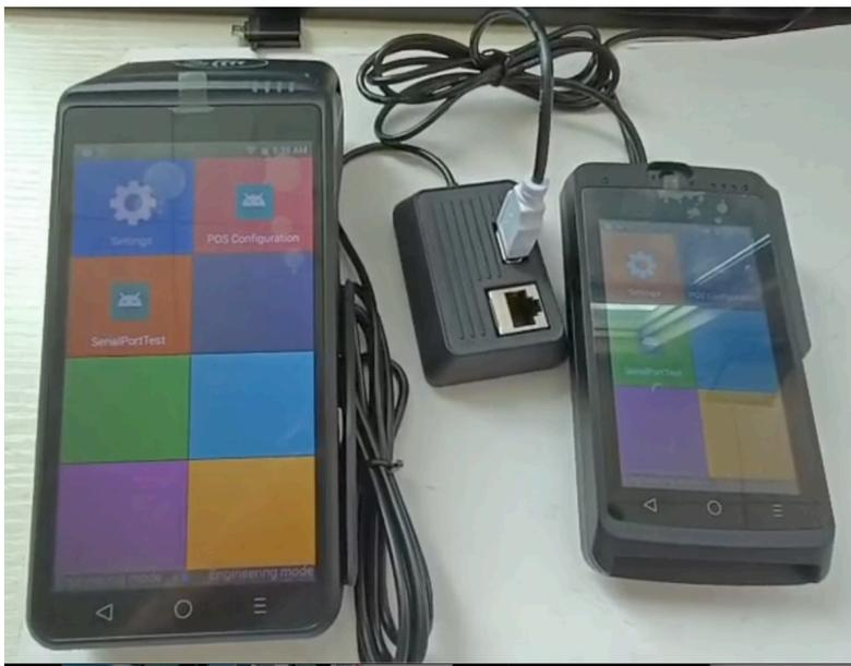
Q3Pinpad使用Hub并通过UU线转接Q2Ethernet
